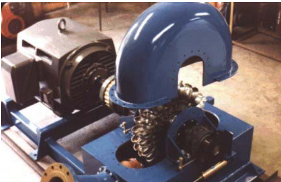
Geopende turbine van een kleine waterkrachtcentrale. Met de doe-fiche 'Sterk water' leer je hoe je zelf zo een waterturbine kunt maken.
